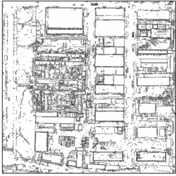
图 5 基于 Canny 自适应检测的 CCD 图像边缘信息
