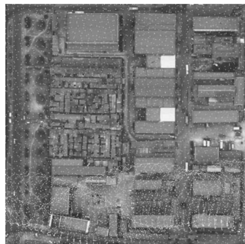
图 3 激光测距点和 CCD 图像的叠加显示
